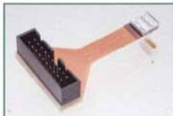
Mictor SB用コネクタを0.5mmピッチコネクタに変換
